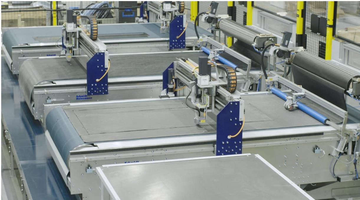
*Cutting & Stacking Zelle für trockene Fasern mit mehreren Schneidtischen des Modells „AutoCut“*
