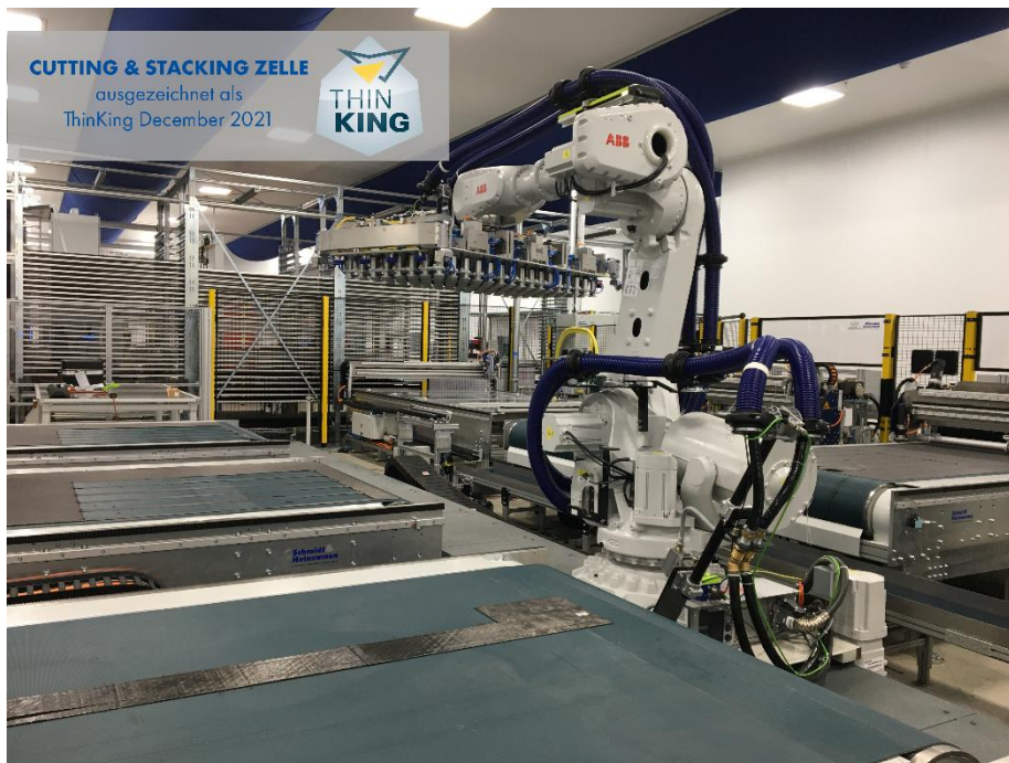
6 Schneidische und ein zentraler Roboter stellen 16 Stacks parallel her Bild: Schmidt & Heinzmann GmbH & Co. KG
